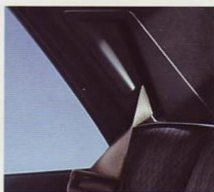
*A l'arrière, le système d'adaptation automatique de la hauteur des ceintures garantit un maximum de confort et une meilleure géométrie de ceinture.*
