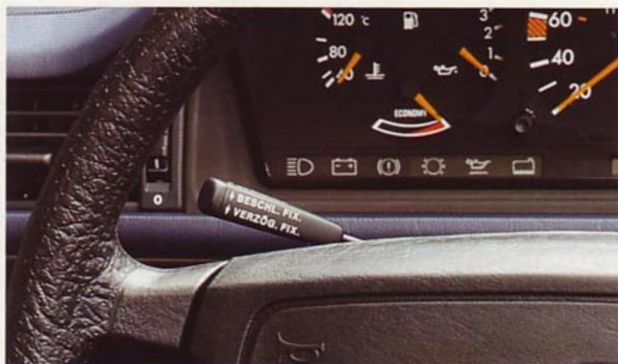
*Pour rouler à vitesse constante sur les longs trajets: grâce au Tempomat, vous bénéficiez d'un plus grand confort et réalisez des économies d'énergie. Ce dispositif maintient la vitesse constante jusqu'à ce que vous freiniez ou accélériez.*
