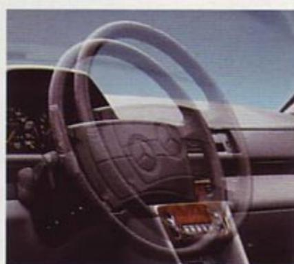
*Le réglage électrique en approche du volant (disponible sur demande) permet une parfaite adaptation à la morphologie du conducteur.*
