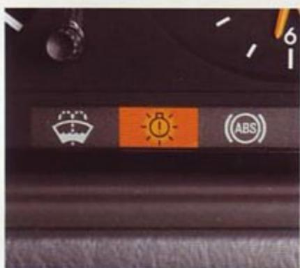
*Le témoin de défaillance des ampoules de l'éclairage extérieur est monté de série sur tous les modèles.*
