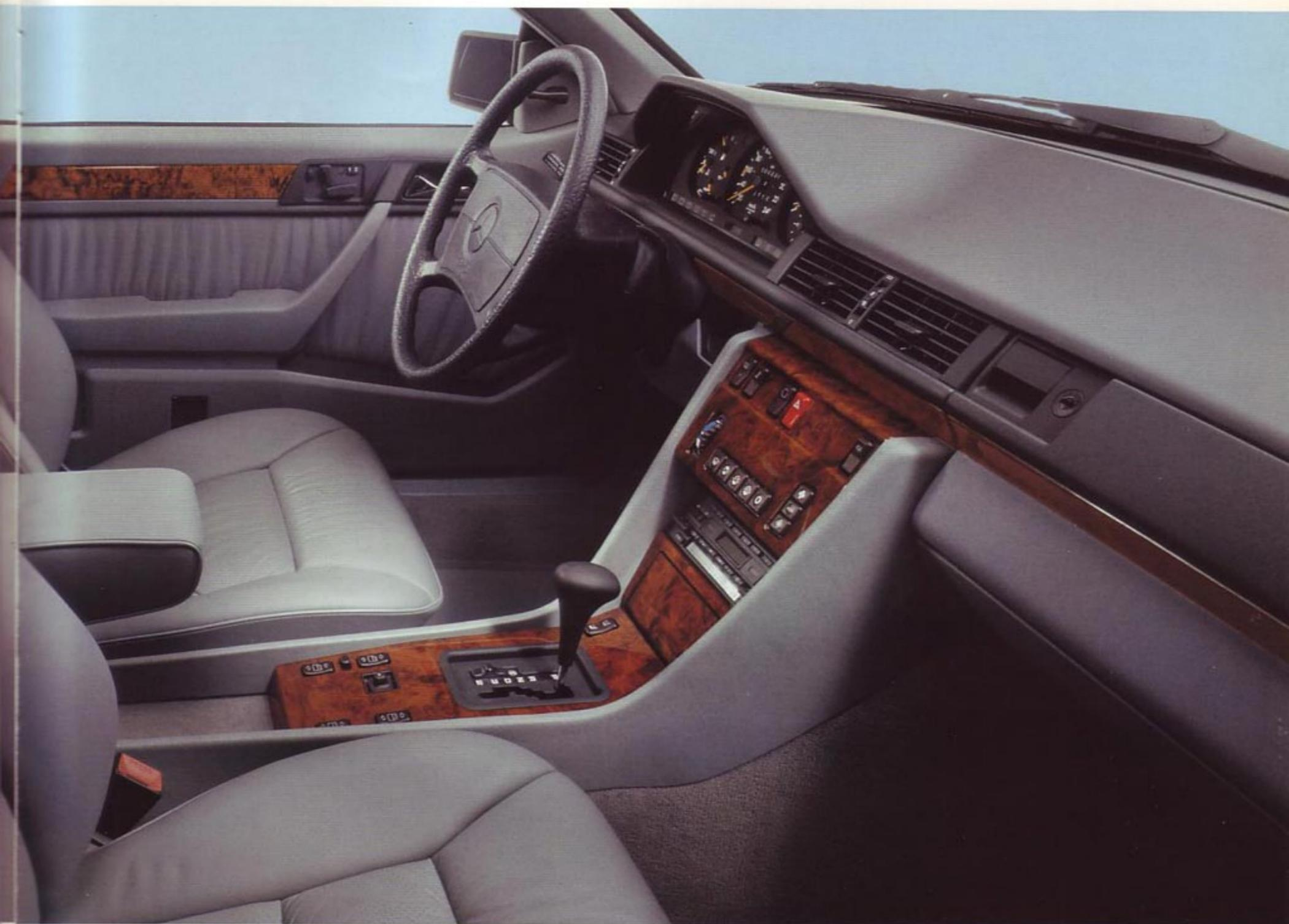
Les mots-clefs de l'équipement des nouveaux coupés Mercedes 230 CE, 300 CE et 300 CE-24: sièges à nouvelle configuration des bourrelets et capitonnage plus ferme; à l'arrière, réglage automatique de la hauteur des ceintures de sécurité; réglage individuel de la hauteur et de l'inclinaison de l'assise du siège conducteur. Rétracteurs de ceinture électroniques aux deux places avant; dispositif d'approche automatique de la ceinture à droite et à gauche. Sur demande:
