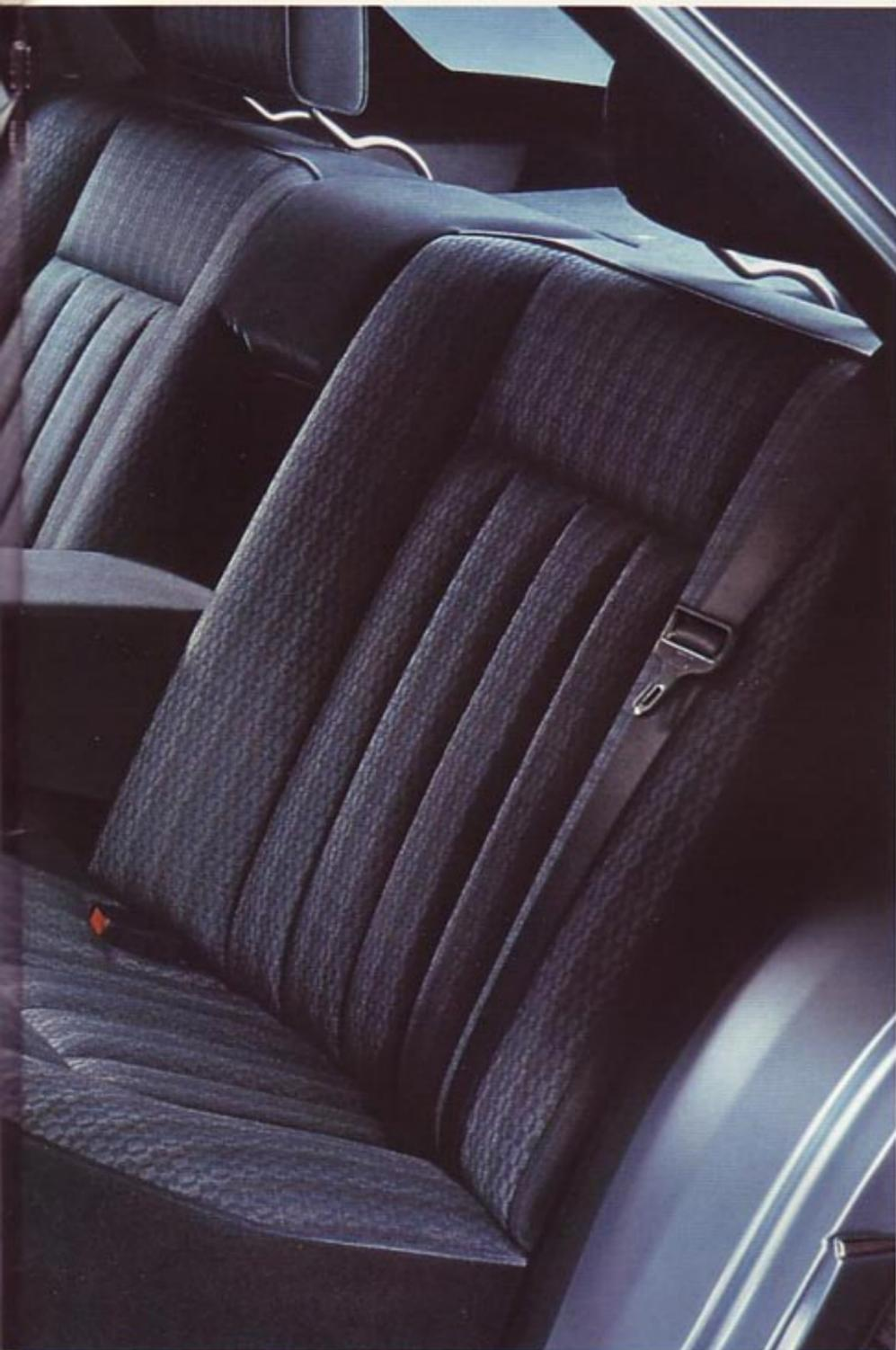
Les mots-clefs de l'équipement: nouveaux sièges assurant un excellent maintien latéral quel que soit le style de conduite - à l'arrière, adaptation automatique des ceintures de sécurité à la morphologie des passagers; réglage individuel de la hauteur et de l'inclinaison de l'assise du siège conducteur. Rétracteurs de ceinture électroniques avant.
