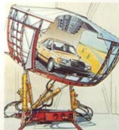
*Grâce au simulateur de conduite le plus moderne du monde, nous étudions et testons de nouvelles solutions techniques dans des conditions proches de la réalité.*
