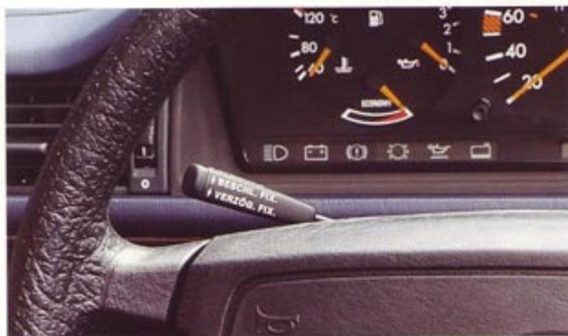
*Pour rouler à vitesse constante sur les longs trajets: grâce au Tempomat, vous bénéficiez d'un plus grand confort et réalisez des économies d'énergie. Ce dispositif maintient la vitesse constante jusqu'à ce que vous freiniez ou accélériez.*
