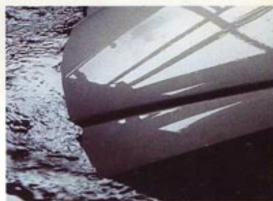
couche débute, après le phosphatage de la tôle, par l'application par trempé cathodique d'une peinture contenant des résines hautement adhérentes, un procédé qui garantit une protection parfaite de la moindre soudure et de la moindre perforation.
