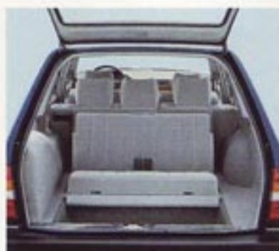
*Grâce à la troisième rangée de sièges (en option), les modèles T peuvent transporter jusqu'à sept personnes. Lorsqu'elle n'est pas utilisée, elle est logée dans un renforcement du plancher.*
