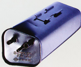
Ce filtre à charbon actif récupère les vapeurs de carburant pour les conduire vers le système d'alimentation lorsque le moteur fonctionne.
