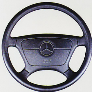
Caché dans le volant, l'air-bag conducteur (série) se gonfle en 0,03 seconde en cas d'urgence.
