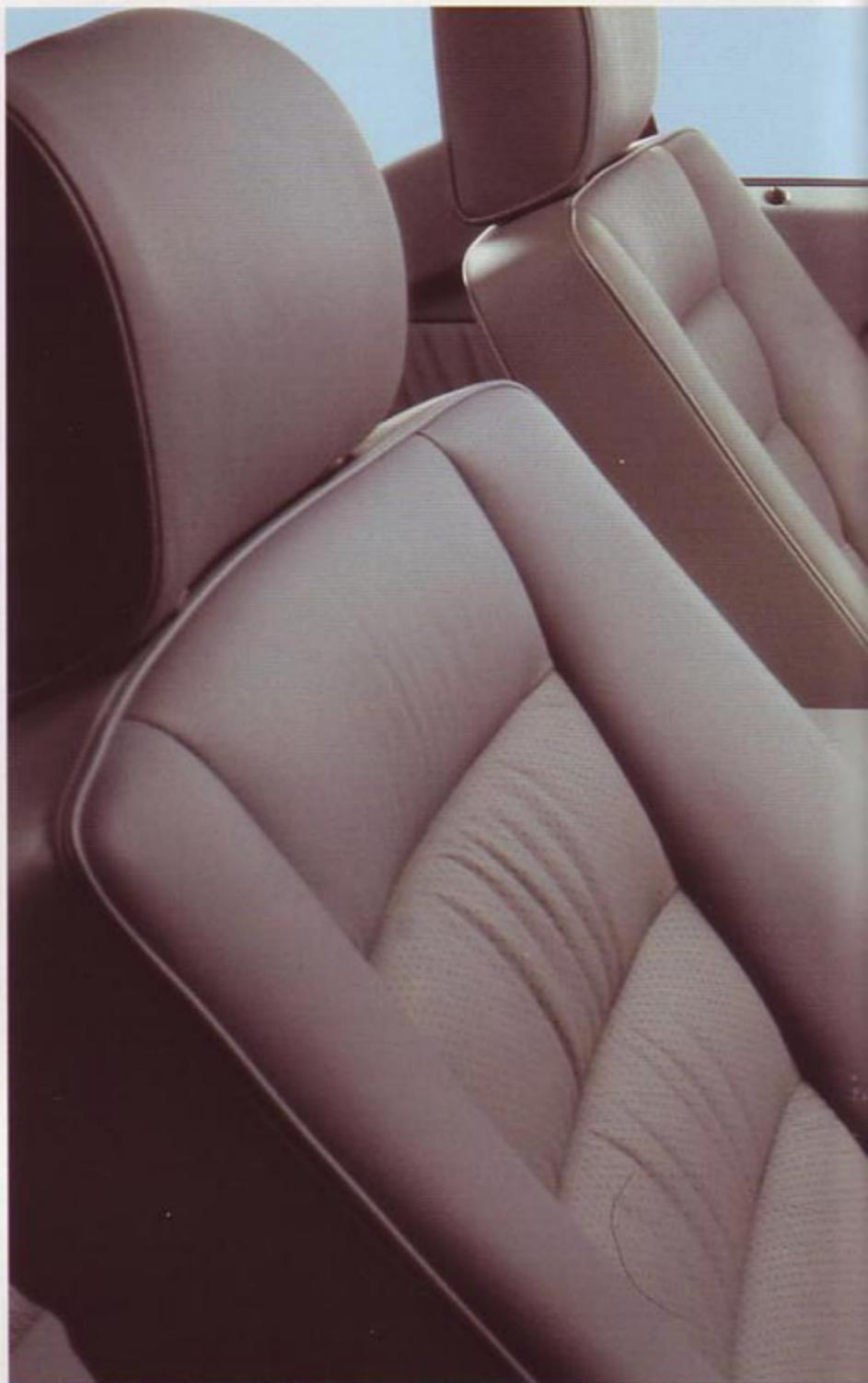
Nouvel aménagement intérieur, confort accru: grâce à l'incurvation plus prononcée des sièges, à la nouvelle configuration des bourrelets et au capitonnage plus ferme, les nouveaux sièges assurent un confort maximal sur les longs trajets. A l'arrière, les ceintures s'adaptent automatiquement en hauteur à la morphologie des passagers. La fixation des boucles de ceintures arrière a été modifiée: elle est encore plus conviviale, les ceintures sont
