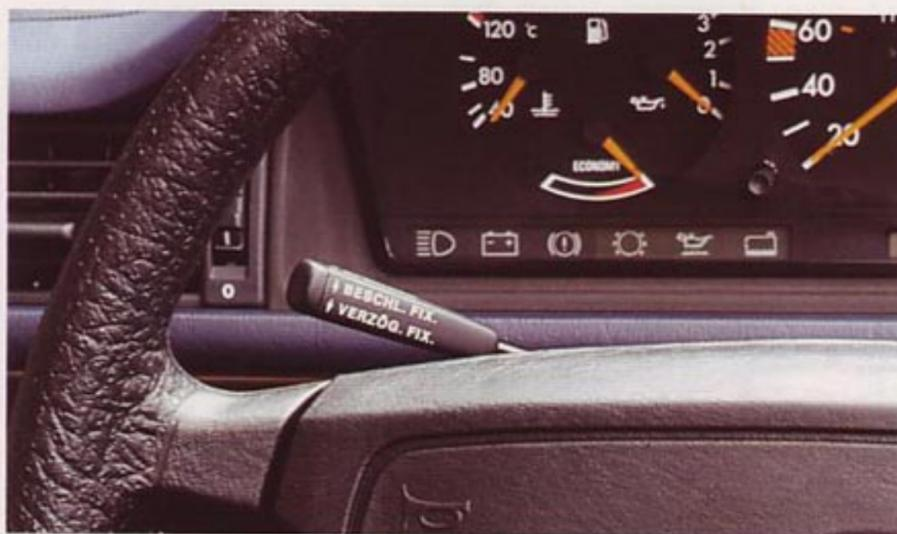
*Pour rouler à vitesse constante sur les longs trajets: grâce au Tempomat, vous bénéficiez d'un plus grand confort et réalisez de économies d'énergie. Ce dispositif maintient la vitesse constante jusqu'à ce que vous freiniez ou accélériez.*
