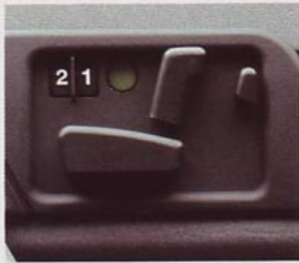
*Le réglage électrique des sièges (sur demande) peut aussi être combiné à un circuit capable de mémoriser deux positions.*
