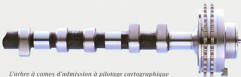
L'arbre à cames d'admission à pilotage cartographique commande automatiquement l'ouverture des soupapes.
