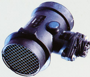
Le débitmètre d'air à film chaud optimise le mélange air-carburant.
