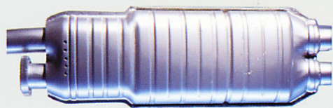
Le catalyseur triple effet des modèles essence.
