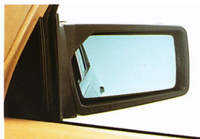
Rétroviseur extérieur droit. Ce rétroviseur élargit votre champ de vision. Réglable manuellement ou électriquement.
