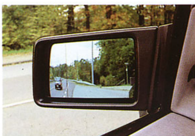
Rétroviseur extérieur asphérique. Une combinaison de miroirs plan et convexe. Réduit l'«angle mort», disponible pour les rétroviseurs chauffants ou non chauffants.
