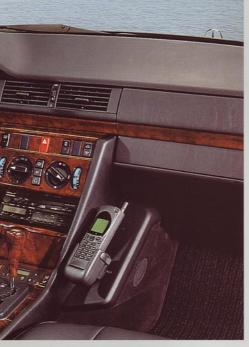
Une communication mobile sophistiquée : portatif ou fixe, le téléphone est logé sur une console de sécurité testée en collision et munie d'un dispositif mains libres. La compatibilité électromagnétique et la fiabilité des appareils ont été sévèrement contrôlés.
