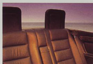
L'arceau escamotable sert aussi d'appuie-tête arrière. Il peut être mis en place par pression sur une touche.
