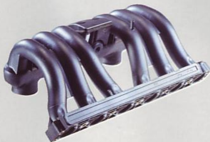
Sur les 6 cylindres essence, le collecteur d'admission à résonance améliore le remplissage des cylindres.
