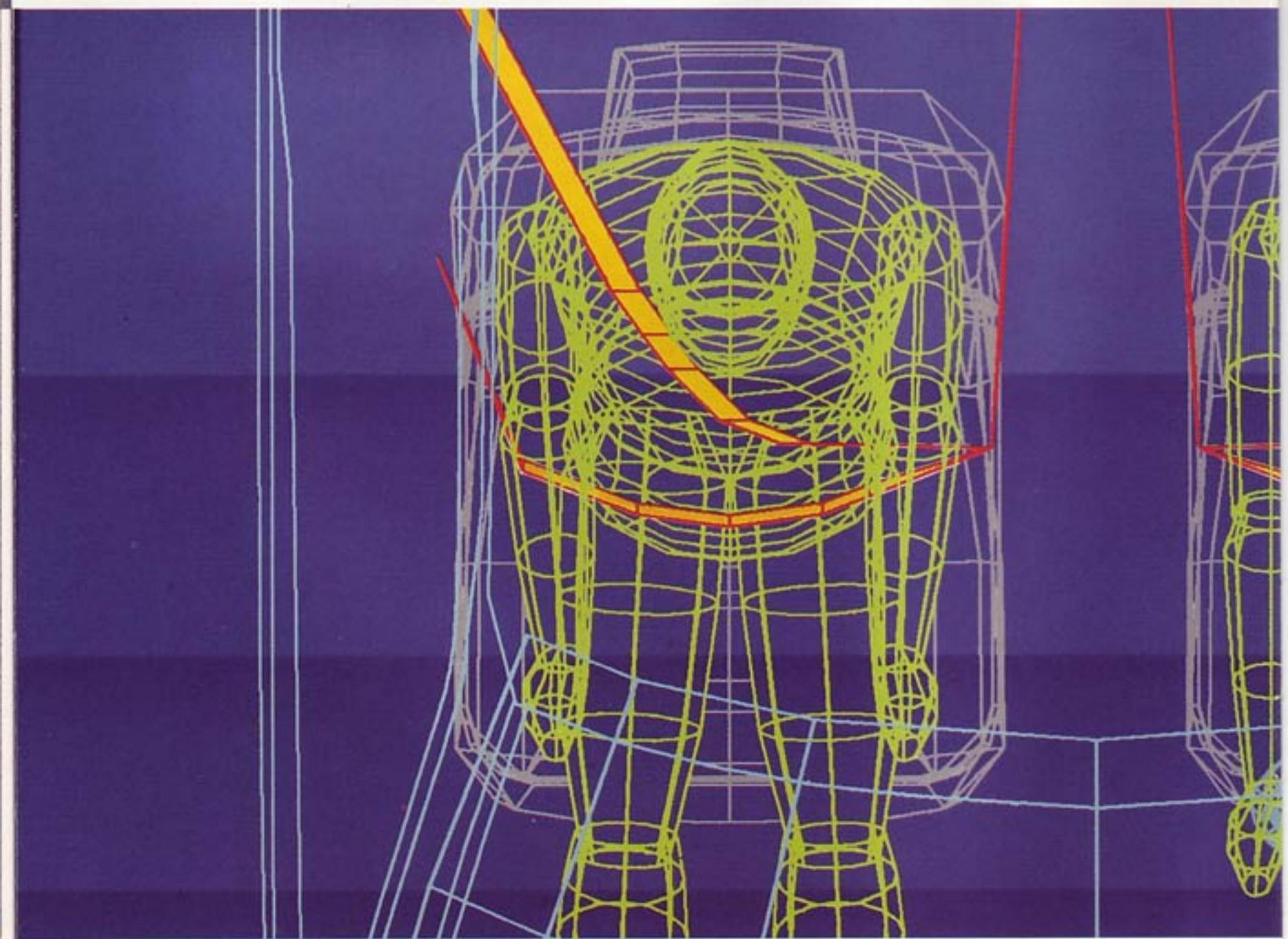
série aux sièges avant augmentent la fonction de protection des ceintures de sécurité trois points à enrouleur.
