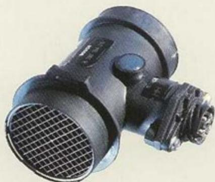
Le débitmètre d'air à film chaud optimise le mélange (sauf E 200).
