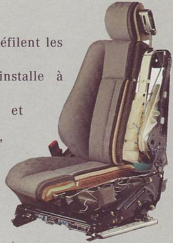
*Nouveaux sièges Mercedes-Benz: des éléments antivibratoires sont intégrés aux ressorts. Les matières naturelles, telles que la laine vierge pour la sellerie, vous entourent, d'un confort optimal, tant sur le plan climatique que sur le plan de la suspension.*
