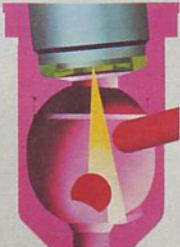
*Exemple de technique de pointe: l'injection oblique permet de réduire considérablement les rejets de particules et de gaz nocifs.*
