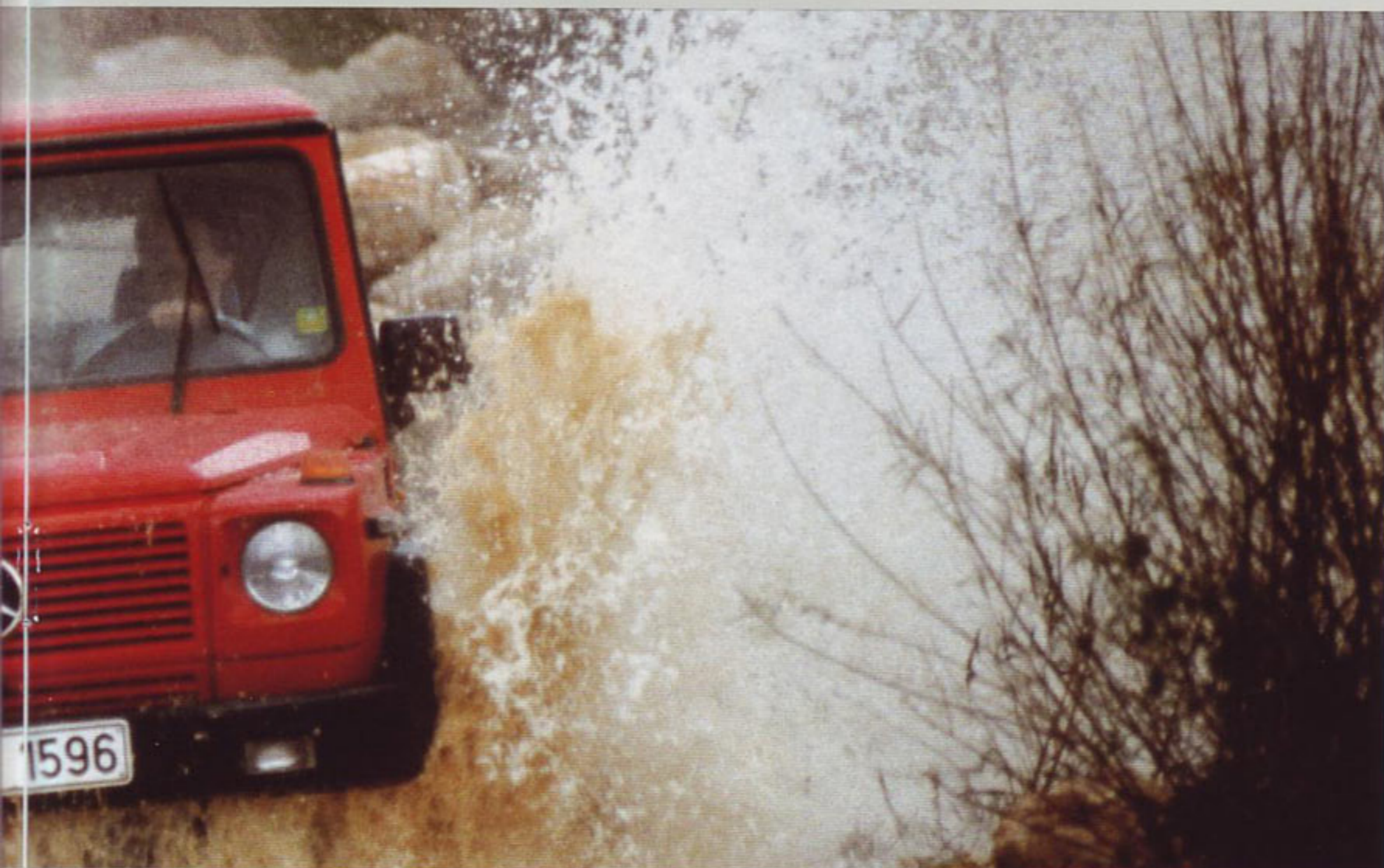
4. Angle d'attaque: 37°, angle de fuite: 32°.
