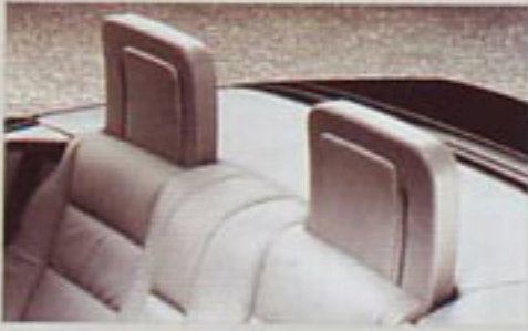
Des appui-tête comme arceau de sécurité.
