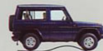
3. Angle de rampe important.
