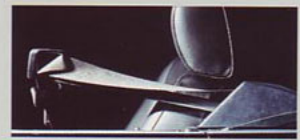
Le dispositif automatique d'approche des ceintures en action.
