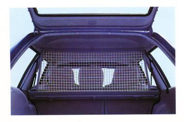
L'autre élément est un filet de sécurité. Il est accroché au pavillon en deux endroits, selon la position du dossier de la banquette arrière, et évite aux passagers arrière d'être heurtés par des objets transportés en cas de freinage brusque ou de collision par l'avant.
