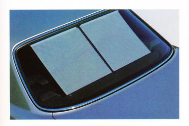
Store de lunette arrière à enrouleur électrique pour les modèles 200-300 et la classe S.
