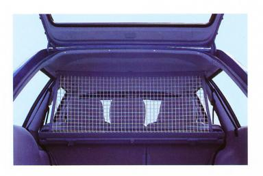
L'autre élément est un filet de sécurité. Il est accroché au pavillon et protège les passagers arrière contre les objets se déplaçant éventuellement en cas de freinage brusque ou de collision légère par l'avant. Le dispositif reste utilisable lorsque le dossier de la banquette est rabattu.
