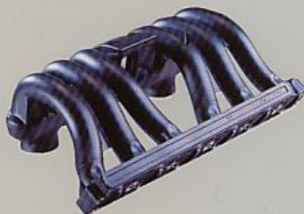
Sur les 6 cylindres essence, le collecteur d'admission à résonance améliore le remplissage des cylindres.
