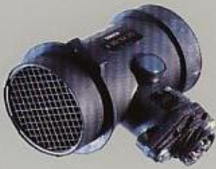
Le débitmètre d'air à film chaud optimise le mélange air-carburant.
