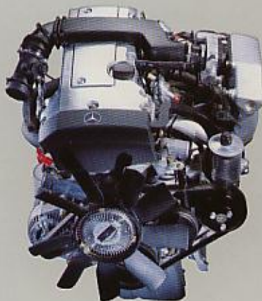
Le 4 cylindres de la E 220 et le 6 cylindres de la E 320 : deux moteurs essence multisoupapes.
