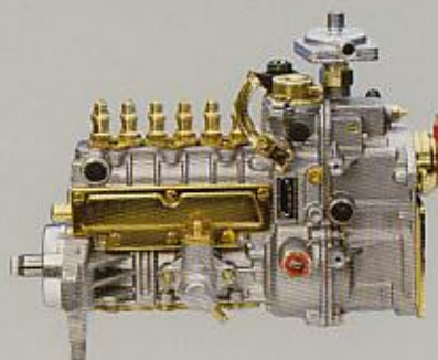
La pompe dose la quantité de carburant à envoyer aux injecteurs.
