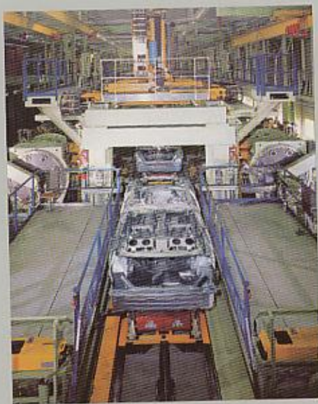
Une chaîne de production flexible pour l'assemblage des carrosseries à Sindelfingen.
