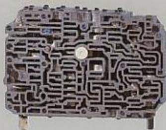
Le bloc-valves est le « cerveau » de la boîte automatique.
