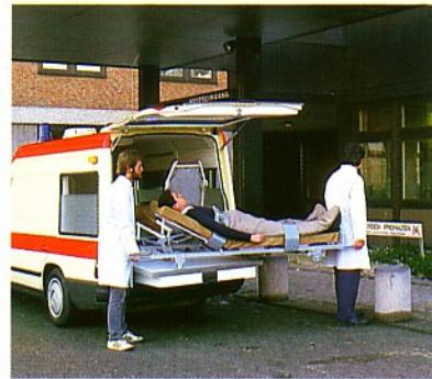
Le hayon arrière d'une seule pièce est équipé d'un moteur électrique permettant l'ouverture et la fermeture rapide et sans effort. De plus, il offre un abri contre la pluie à ne pas négliger.
