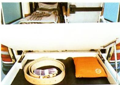
Le stockage du matériel dans le tiroir-plateforme, permet une arrimage sûr et élimine les bruits habituellement connus. De plus, l'accès à ce matériel est on ne peut plus aisé. Enfin, la répartition du poids de ce matériel près du centre de gravité évite une surcharge latérale.
