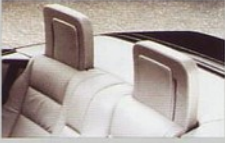
Ausfahrbare Kopfstütze als Überrollschutz.
