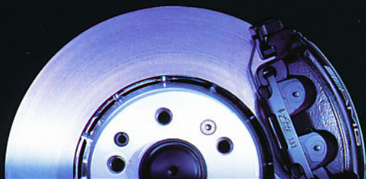
Une technique issue des circuits : le disque est désolidarisé du plateau-support par 12 tiges en acier spécial.
