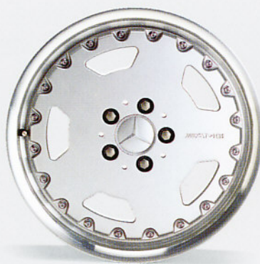
Roue-disque AMG en plusieurs parties
